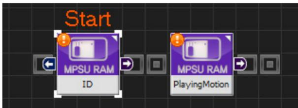
한편, MPSU RAM, Servo RAM, OPSU RAM 중에는 값을 읽을 수만 있고 쓸 수 없는 센서 값, 위치 정보 등의 항목도 존재합니다. 이 경우에는 입력 핀이 없어지며 대입이 불가능합니다.
