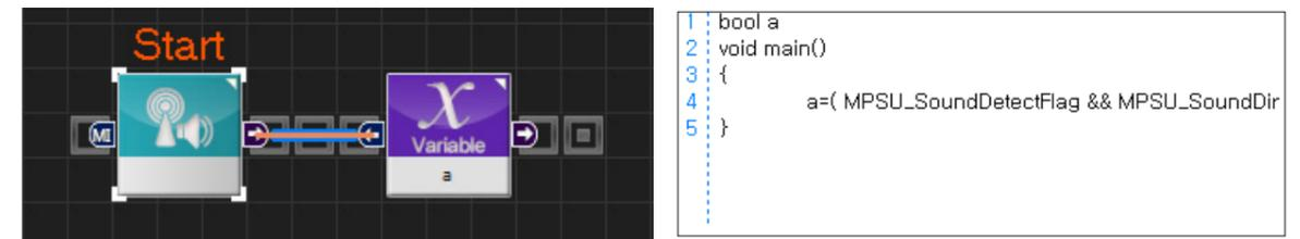
Sensor 모듈 팩과 Communication 모듈 팩에 속한 모듈들과 Data의 Constant, ETA의 ETA Sensor 모듈은 단독으로는 스스로 변환되지 못하며, 출력 핀이 다른 입력 핀과 연결 되어야만 의미를 가집니다. 단독으로 스스로 변환되지 못할 때, 모듈의 왼쪽 상단에 오류가 표시됩니다.
